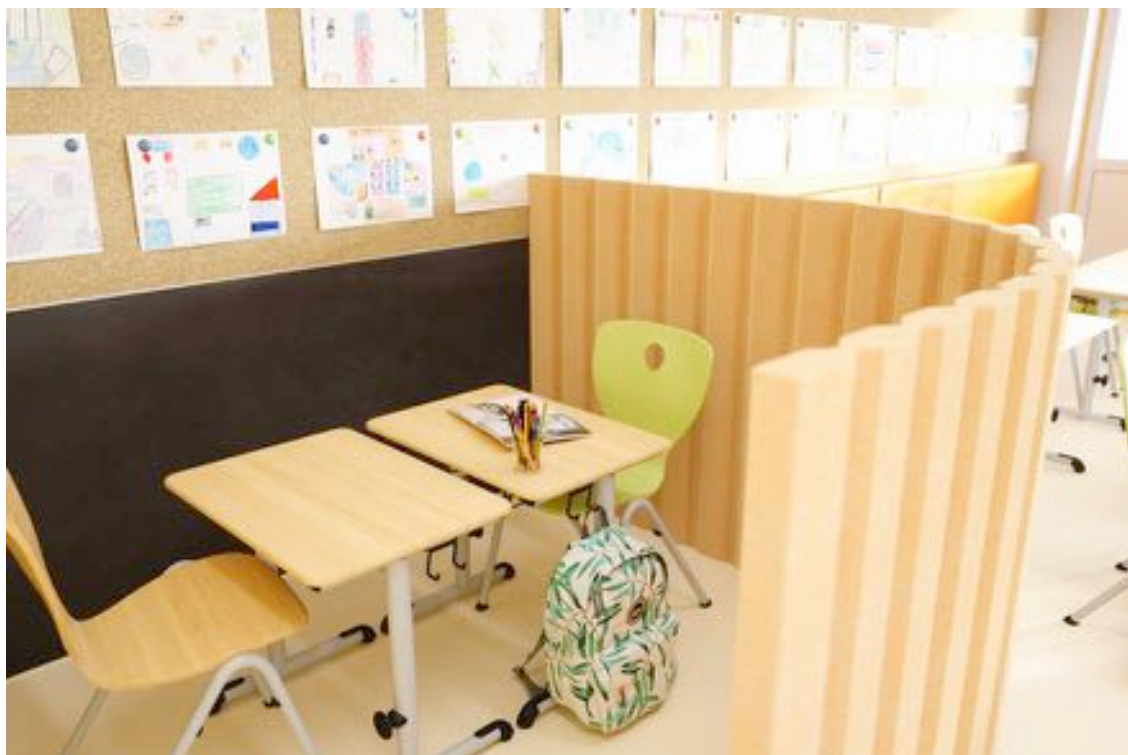
Slika 39: Prostor za individualno delo, ki se oblikuje s pomočjo premičnega zvočno izolativnega panela
